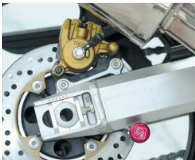
Feines Detail: Prismenaufnahmen an der Hinterachse, leichter Bremssattelträger
